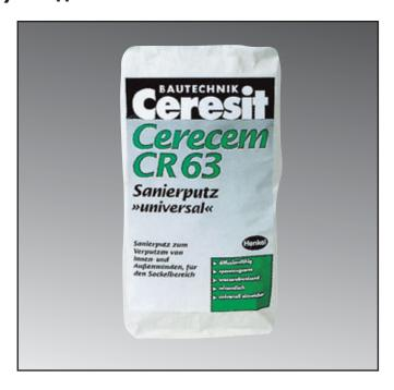
ния адгезионной смеси в качестве жидкости затворения для Сегеsit CR 63 используют Ceresit CC 81, разбавленный водой в соотношении 1:3 соответственно. Количество жидкости затворения определяется требуемой для обрызга консистенцией смеси. Адгезионная смесь наносится на основание при помощи кисти или кельмы, покрывая равномерно не менее 50% поверхности основания в виде сетки. Для смешанных кладок, кладок из пористых и силикатных кирпичей толщина обрызга должна быть около 5 мм.
